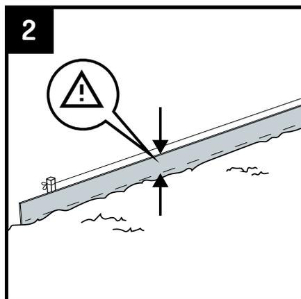
2 Coloque la bordura en la zanja. Asegúrese de que al menos la mitad de la pieza quede en el suelo. La bordura será aún más estable si se coloca a mayor profundidad en el suelo. La bordura se puede acortar con una sierra manual para madera.
