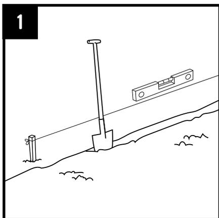
1 Cave una franja. Asegúrese de que al menos la mitad de la bordura pueda desaparecer en la zanja. Para un contorno recto, utilice cuerdas y estacas para marcar la línea sobre la que se debe colocar el Multi-Edge ECO para obtener un resultado más ajustado.
