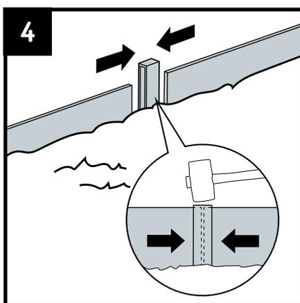
4 Se pueden introducir los extremos de la bordura en el perfil de una estaca. Esto no es necesario, pero podría proporcionar más estabilidad y ajuste. Se pueden crear esquinas cortando la bordura y colocándolo una contra otra en el ángulo deseado.
