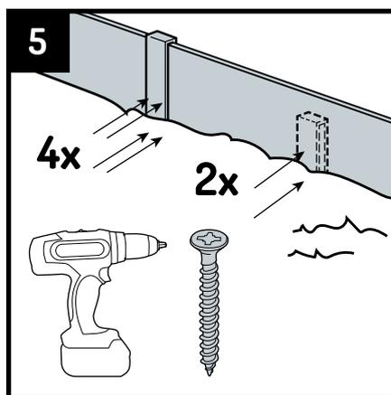
5 Golpee con cuidado el borde hasta la altura deseada con un mazo de goma. Atornille las estacas a la bordura. Utilice 2 tornillos de acero inoxidable de 4 x 30 mm. Atornille una estaca utilizado como transición entre dos borduras con 4 tornillos.
